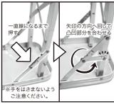
③ベンチの脚部をしっかりと広げて、ロック パーツの凹部分がテーブルの凸部にロック されるように固定します。
