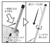
④次にテーブルの脚部をしっかりと広げて、 片方のベンチの裏側に収納されていたテー ブルの脚を差し込みます。
