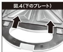
プレートロックボタンを奥にずらしてプレートロックを解除しプレートを手前に取り出します。
