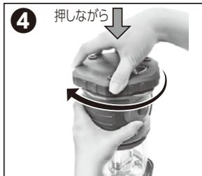
『電池ボックスカバー』を下に押しながらかつ上図の矢印方向へ回し、しっかりとロックして完了です。(※1)
