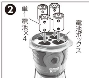
『電池ボックス』に単1電池4個を本体の刻印に従って＋(プラスマイナス)を正しくセットします。
