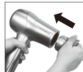
吹出口に専用ノズルをそえて、「カチッ」とはまる音がするまで押し込みます。
