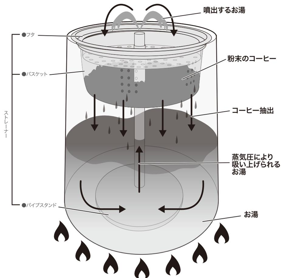
直火で熱くなったお湯が、蒸気圧により『ストレーナー』の『パイプスタンド』から吸い上げられ噴出します。このお湯が『バスケット』内のコーヒー豆にかかることで、コーヒーが抽出される仕組みです。この循環が繰り返されることにより、コーヒーが徐々に濃くなっていきます。
