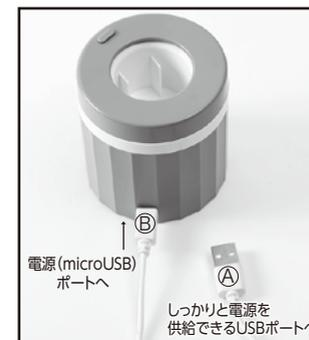
お手持ちのUSB-ACアダプターやパソコン本体のUSBポートに付属のUSBケーブルを(A)を接続し、もう片方(B)を台座側の電源(microUSB)ポートに差し込みます。
