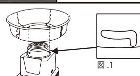
トレイ内側のツメを、本体側部に沿って下までまっすぐ下ろします。そのツメが本体の図.1の部分にはまるように回して固定します。
