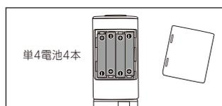
③ カバーのくぼみがない方のツメを先に差し込んでから、反対側（くぼみがある方）を押し込んでカバーを閉じます。
