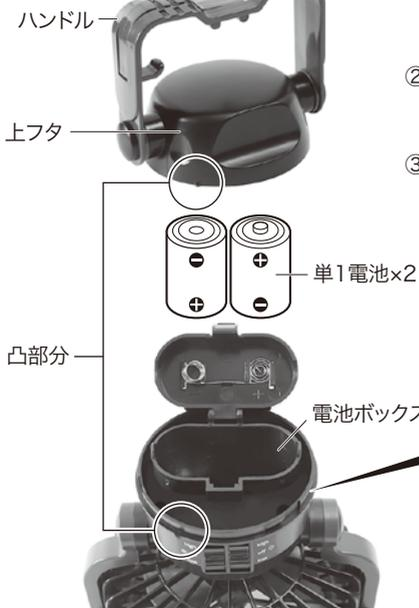
①【図.1】の『凸部分』が重なるように『上フタ』を半時計回りに回してロックを解除して本体の『上フタ』を外します。
