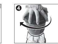
『電池ボックスカバー』を下に押し ながら上図の矢印方向へ回し、 しっかりとロックして完了です。
