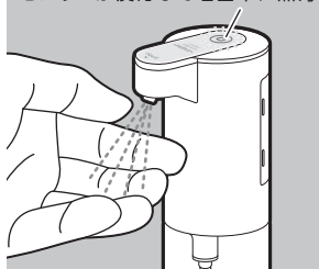
センサーが反応して吐出中に点灯
