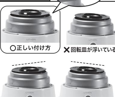
『回転皿』は本体の軸に対し**垂直になる**ようにお取り付けください。傾いている場合や『回転皿』が本体に擦れたりしている場合、事故や故障の原因になりますので正しくお取り付けください。
