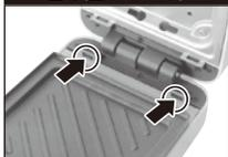
プレートの突起を、本体の図.1の○で囲まれた部分に差し込み、ツメがプレートロックに固定されるよう『カチッ』と音がするまで上から押します。
