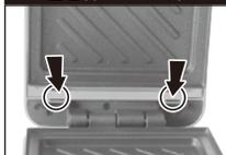
プレートの突起を、本体の図.2の○で囲まれた部分に差し込み、ツメがプレートロックに固定されるよう『カチッ』と音がするまで上から押します。
