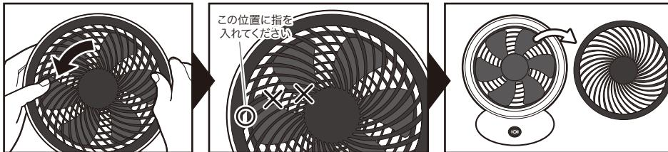
前面ガードの隙間に人差し指を入れ、下に力を加えてロックを解除してください。硬いので音が鳴るまで強く押し込んでください。
