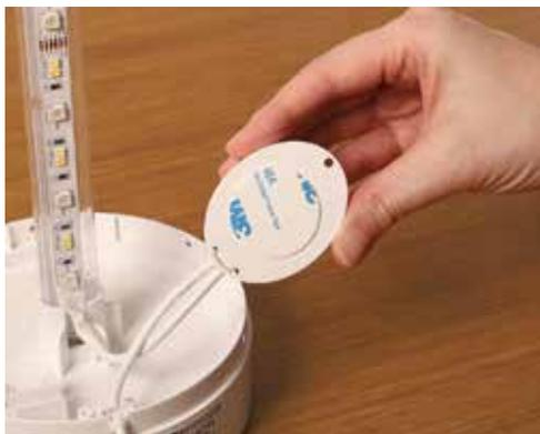
4-3. 両面テープを取り付けたリモコン信号受信部分をベースに貼り付けます。
