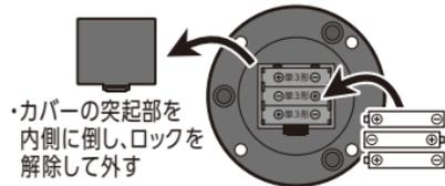
・カバーの突起部を内側に倒し、ロックを解除して外す
