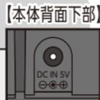
※DC6VなどDC5Vを超える出力電圧のものを使うと壊れます。
